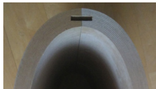
Beispiel Nutung der Längskante an einem Ellipsenprofil, zur Verwendung als Säule
