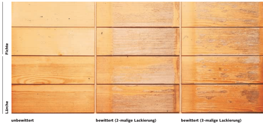
Bild 10 Nach dreijähriger Freibewitterung weitgehend zerstörter Klarlack auf Nadelholz (obere 2 Reihen Fichte, untere 2 Reihen Lärche). Linke 4 Proben unbewittert, mittlere 4 Proben bewittert (zweimalige Lackierung), rechte 4 Proben bewittert (dreimalige Lackierung). Verschärfter Freibewitterungsversuch (EMPA).
