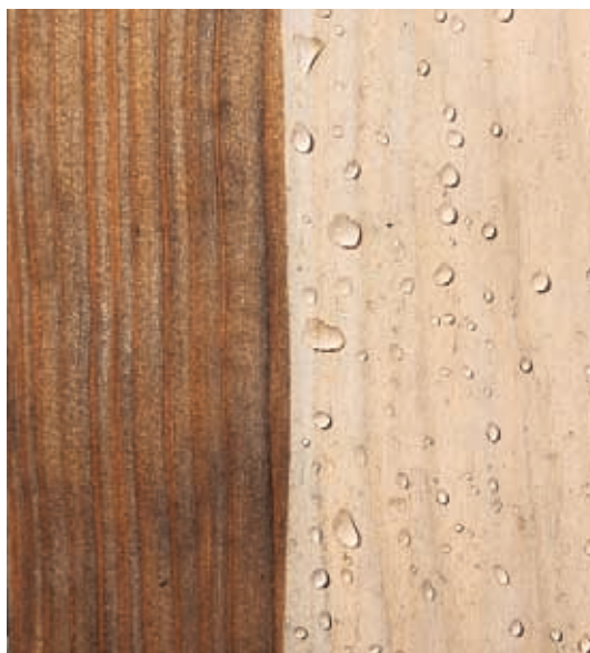
Bild 11 Mit wasserabweisender, farbloser Imprägnierung behandeltes (rechts) und unbehandeltes Brett (links) aus Fichtenholz nach einjähriger Freibewitterung. Vom imprägnierten Brett perlt das Regenwasser ab, während die Oberfläche des unbehandelten Brettes durchfeuchtet wird und sich dadurch dunkel verfärbt. Auf die Dauer wird auch das imprägnierte Brett verwitterungsbedingte Verfärbungen zeigen (EMPA).
